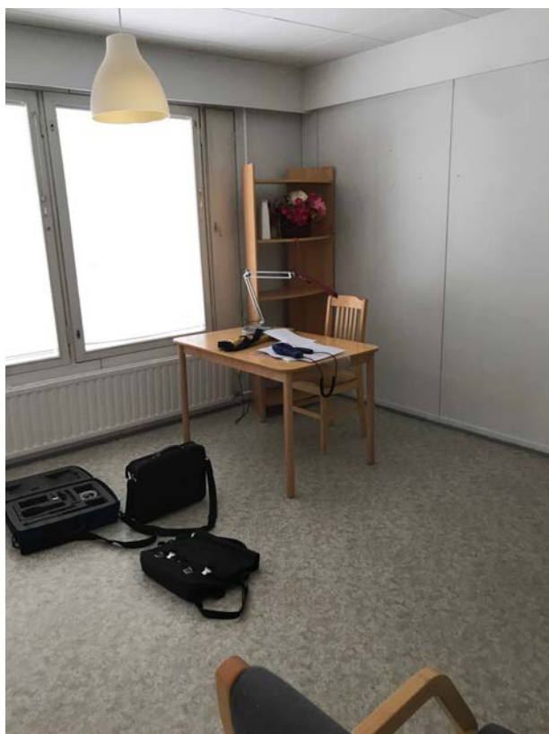
Asunto yksi: yleiskuva. Lattiassa muovimatto, seinissä lastulevy, katossa Haltiksi.
